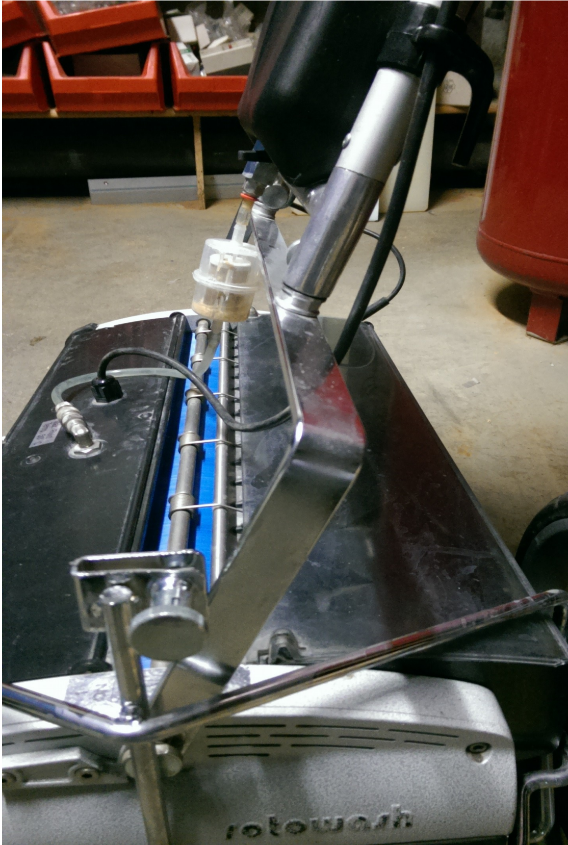
Abbildung 5: Wassertank, Absperrhahn und Wasserfilter für Frontdüsen
